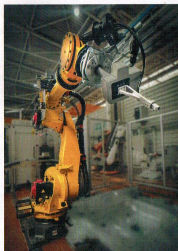
Roboter zur kontaktlosen Prüfung von Schweißpunkten in der Automobilindustrie: Das Prüfsystem ermöglicht eine vollständig roboterbasierte Prüfung und eine zuverlässige Unterscheidung zwischen iO- und niO-Schweißpunkten in der Produktionslinie. Bilder: Xarion Laser Acoustics
